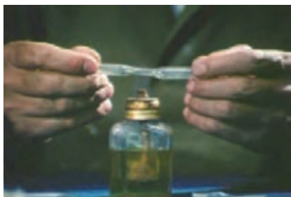
ساخت بطری‌های شیشه‌ای از لوله خودکار
