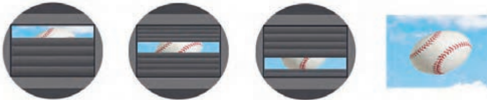
دریافت شکاف نور با استفاده از شاتر در دوربین
